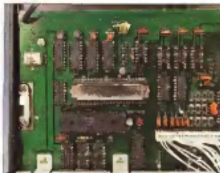
▲ La CPU, il solito Z80 A e, accanto al sistema di raffreddamento, il processore video VG 9331. Nella foto in alto si notano la disposizione dei connettori sul retro, numerata nel suo proprio ordine.
